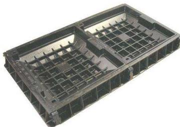
**Chiusino 60x120** a riempimento in ghisa sferoidale classe D 400 (rispondente alla norma EN124). Permette il riempimento con qualsiasi tipo di materiale (porfido, basoli, granito), in modo da mantenere la continuità della pavimentazione.
